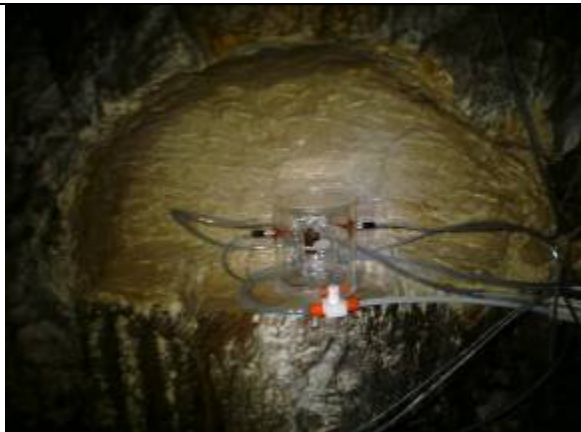
Figure 5 : Photo de capteur de déplacement situé le plus au Nord et du capteur situé au centre de l'instrument NS.
