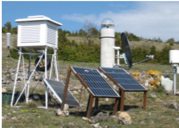
Figure : Station GPS de la Salvetat (SLVT), avec le système GPS, la station météorologique et le système de transmission satellitaire des données.
