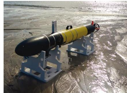
Capteur radiométrique marinisé
