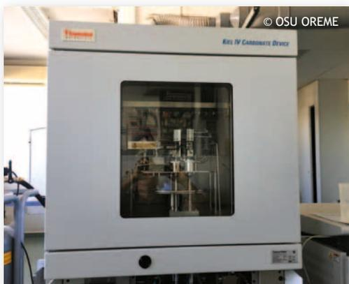
Préparateur automatique de micro-échantillons de carbonates pour l'analyse des compositions isotopiques en O et C (ThermoFisher Kiel IV couplé à un spectromètre de masse de type DELTA V+).
