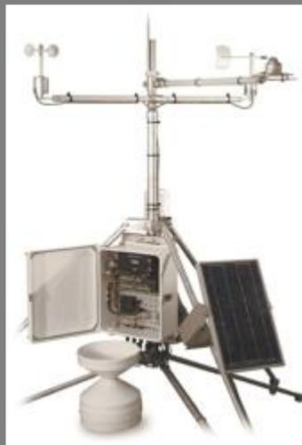
Capteurs température, anémomètre, hygrométrie, pluviométrie (Campbell Scientific)
